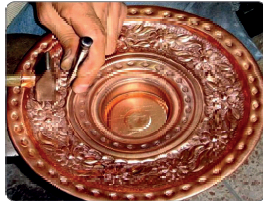
Metal, darbe alırsa bir dereceye kadar parçalanmadan şekil değiştirir.
